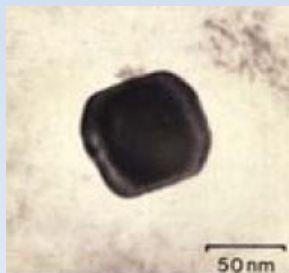
La copa de Lycurgus (Egipto siglo IV a.c.): vidrio de sílica con nanopartículas de plata y oro de ~70 nm
